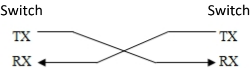
Figure 7-3 Conexión del cable de fibra óptica
